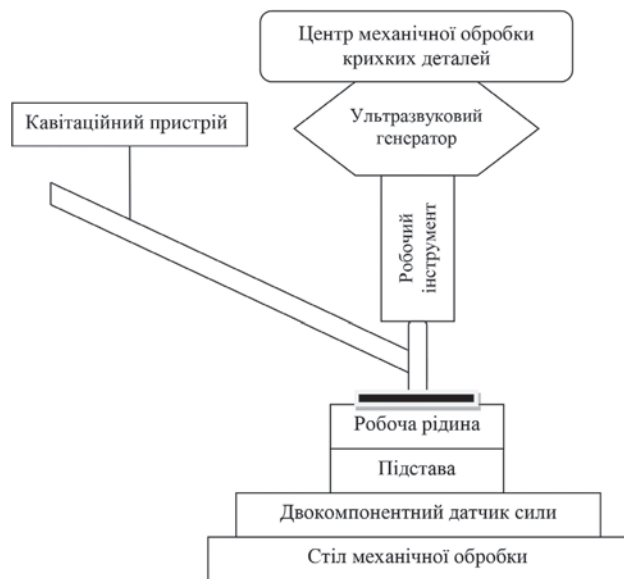
Рис. 1. Схема ультразвукової установки для проведення механічної обробки крихких матеріалів
