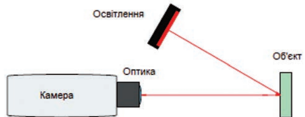
Рис. 1. Структура оптичної системи вимірювання відстані між об'єктами
